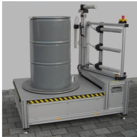
Fassmessanlage „light“: Den DL-Scanner für reine Dosisleistungsmessung entwickelte Marschelke Messtechnik im Jahr 2008 im Auftrag des Forschungszentrums Jülich
