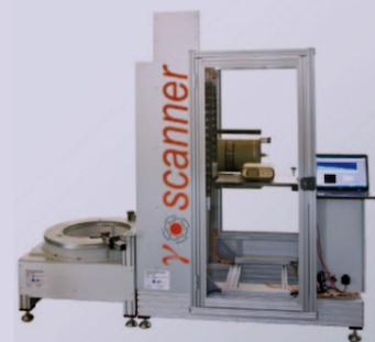
Wer wissen will, was in einem Fass ist, ohne es zu öffnen, braucht gute Ideen. Im Gamma-Scanner von Marschelke Messtechnik stecken eine ganze Menge davon. Die Anlage ist ein modular aufgebautes Komplettsystem zur Messung von Fässern mit radioaktivem Abfall. Scanner und Software sind gemeinsam mit dem Forschungszentrum Jülich entwickelt und durch das Forschungszentrum qualifiziert.
