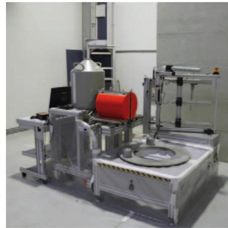
Weiterentwicklung mit Gamma-Spektrometrie: Der Rapid-Scanner aus dem Jahr 2010 erhielt einen Germanium-Detektor mit vertikalem Schlitz-Kollimator
